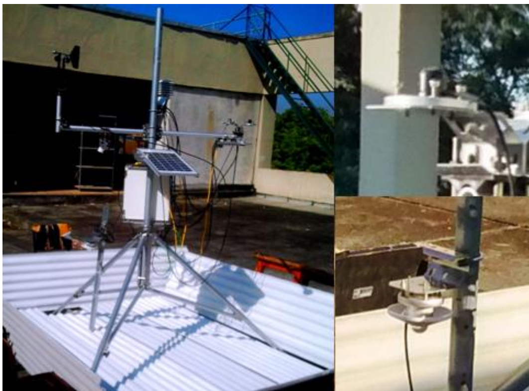
Figura 3.7. Equipamento para obtenção do albedo para a telha de fibrocimento com camada de tinta branca.
